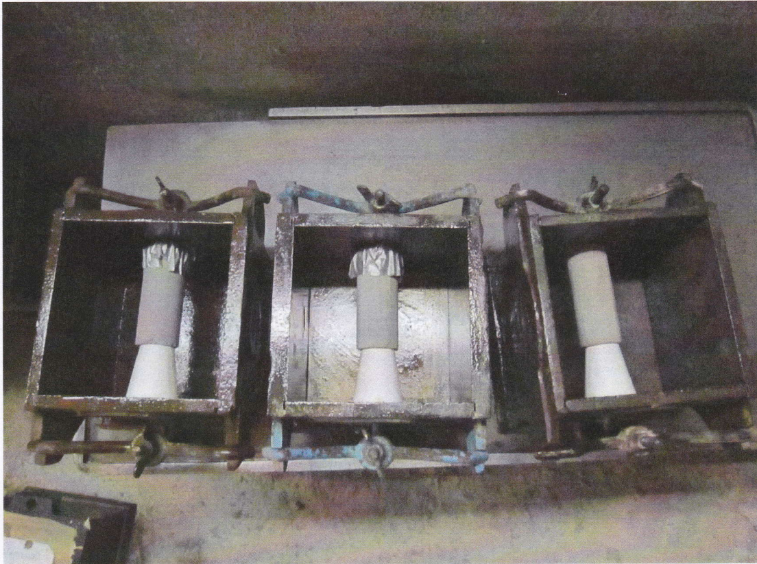
Bild 1: Proben mit großem Konus vor dem Betonieren
