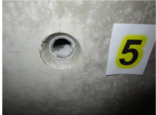
Beispiel der Einklebung an Sichtbetonkegel „MARO® - Kegel Artikel Nr. 2440 1043“ (Probekörper Nr. 5)
